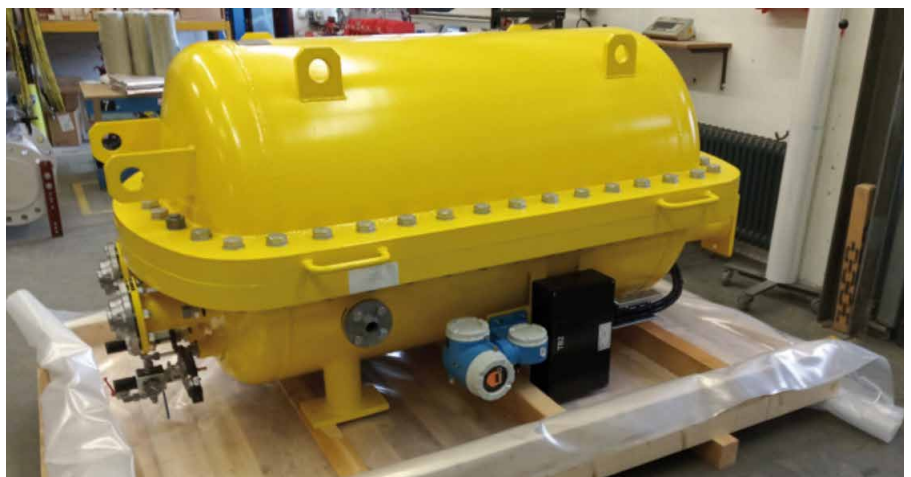
Eine der E-GVUs für die Schiffe von Hurtigruten, die gerade für den Versand vorbereitet wird.
