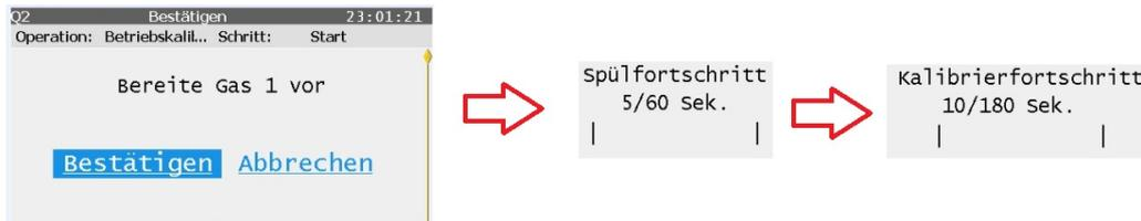
5. Zuerst wird mit Kalibrierungsgemisch gespült. Dieses wird, wie auch die Dauer des Vorgangs angezeigt. Danach wird das Betriebskalibrierungsgas gemessen. Die Dauer dieses Vorgangs wird ebenfalls wieder angezeigt.
