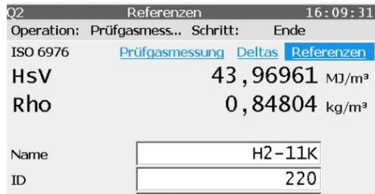
3. Wechseln Sie zurück zu **Prüfgasmessung** und aktivieren Sie **"Start"**
