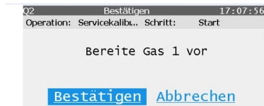
Die Prozedur startet automatisch. Zuerst wird mit Kalibriergasgemisch gespült. Dieses wird, wie auch die Dauer des Vorgangs angezeigt. Danach wird das Gas gemessen. Die Dauer dieses Vorgangs wird ebenfalls angezeigt.
