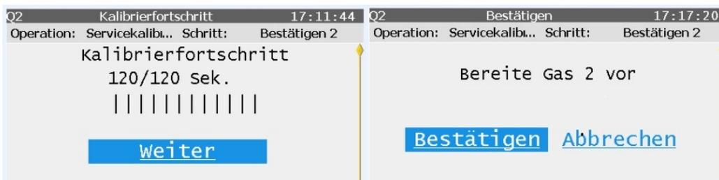
5. Analog zu Gas 1 wiederholt sich der Vorgang. Nach Vermessung des 2. Gases wird für den Umstieg auf den Analysebetrieb erneut **"Weiter"** im unteren Teil der Anzeige eingeblendet. Wählen Sie **"Weiter"** und stellen Sie die Verbindungen wieder her, wie sie vor der Servicekalibrierung waren! **Testen Sie die Dichtigkeit!**
