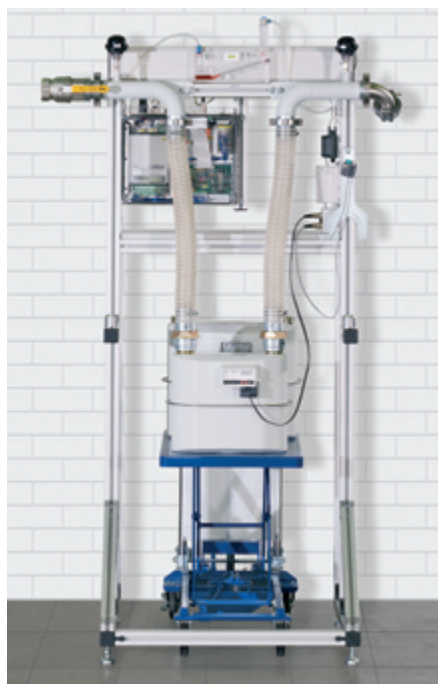
Prüfstrecke für Gewerbegaszähler
