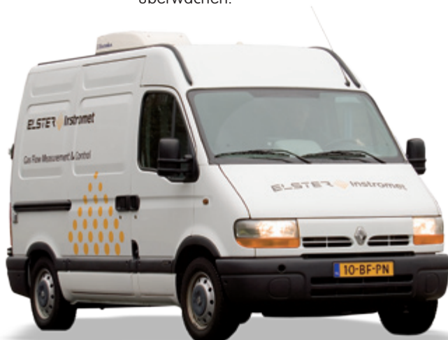
Das Servicemobil – ein mobiler Düsenprüfstand als Einzelprüfplatz BKG 2,5 – BKG 25
